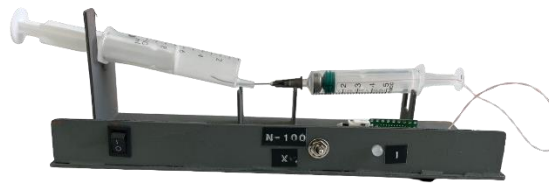
Рисунок 2. Макет генератора водорода на основе водородной ячейки
