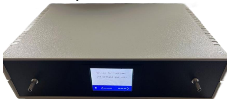
Рисунок 3. Внешний вид макета устройства для определения водорода и метана в выдыхаемом воздухе
